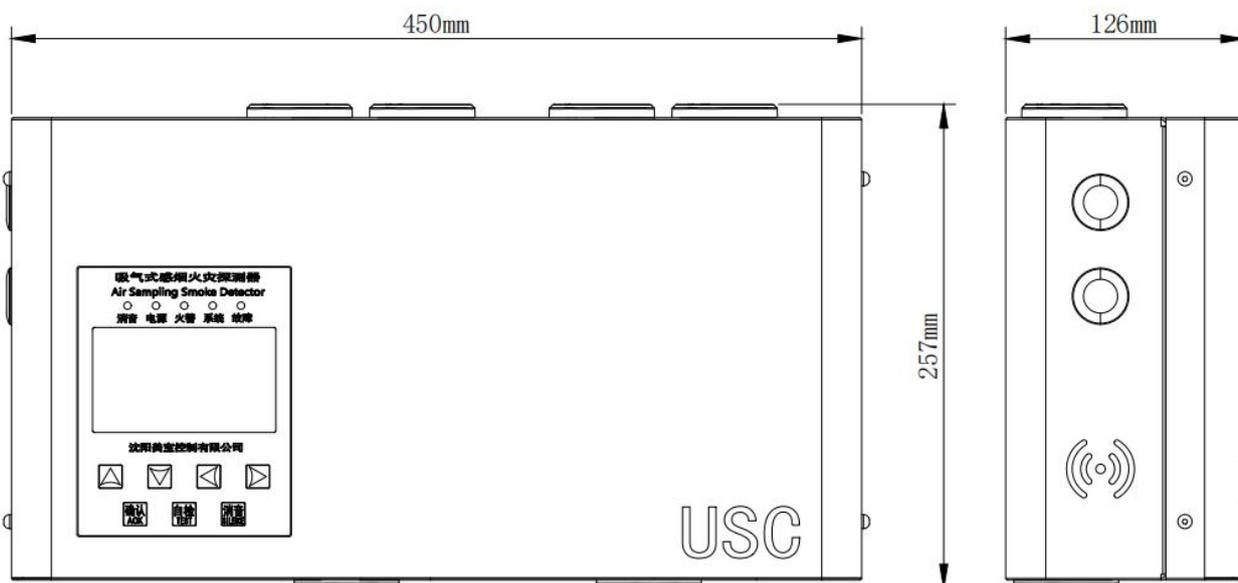
USC4940 吸气式感烟火灾探测器尺寸图 (5-1)
